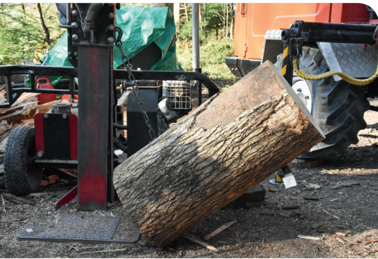
Il sollevatore di tronchi consente di lavorare con meno sforzo per il corpo.
