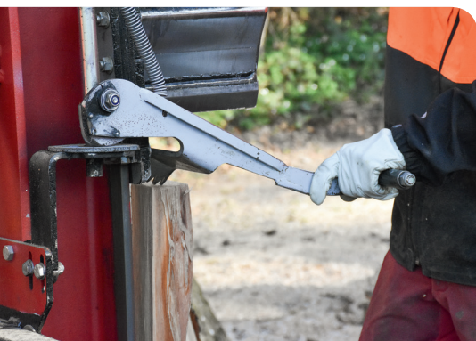
La griffe de retenue permet de positionner et de maintenir sans danger les billes et les quartiers lors du processus de fendage.
