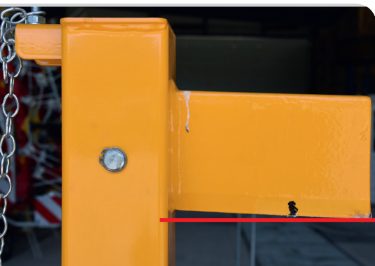
Grâce à l'angle de coin croissant de >3^\circ , le bois est tiré vers la colonne de fendage.
