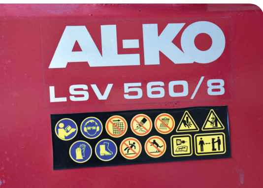
Les avertissements et les signaux d'obligation doivent être visibles sur la machine.
