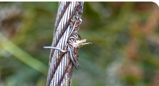
Les câbles de traction défectueux doivent être remplacés ou raccourcis dans les règles de l'art.
