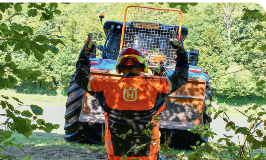
Positionnement sûr du treuil à câble via l'instruction par une personne auxiliaire.
