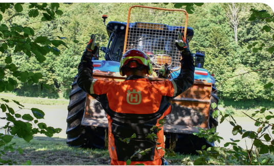
Sichere Positionierung der Seilwinde über das Einweisen durch eine Hilfsperson.
