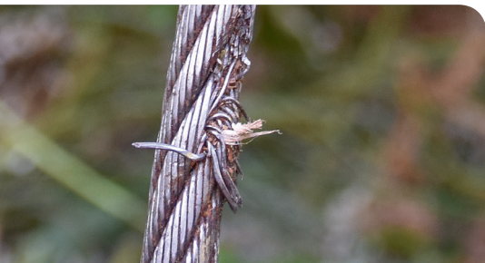
Defekte Zugseile sind zu ersetzen, bzw. fachgerecht zu kürzen.
