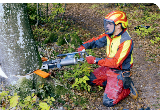
Il cuneo idraulico consente di abbattere senza vibrazioni. (Foto: Bundesforschungszentrum für Wald (BFW)/Lackner)
