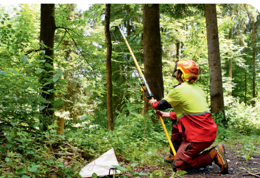
Posizionamento sicuro della fune dal suolo tramite fionda a sacchetto.
