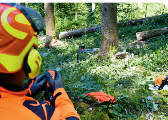
Grazie al radiocomando, durante l'utilizzo del cuneo di abbattimento a radio l'operatore rimane al di fuori dell'area di caduta.
