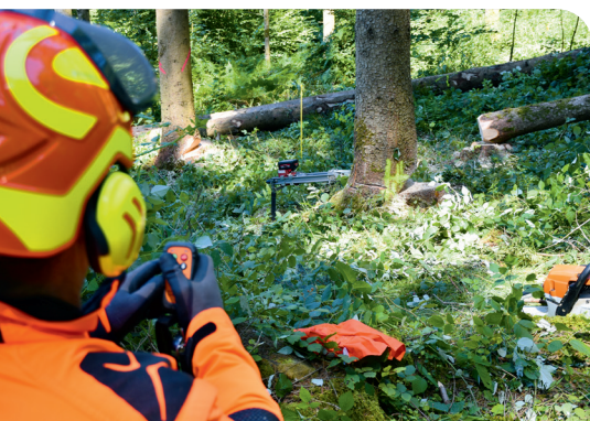
Grâce à la télécommande radio, l'opérateur reste en dehors de la zone de chute pendant l'utilisation du coin d'abattage radiocommandé.
