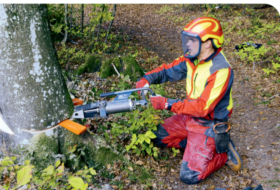
Le coin d'abattage hydraulique permet un abattage sans vibration dans le tronc. (Photo: Bundesforschungszentrum für Wald (BFW)/Lackner)
