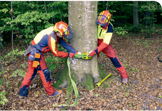
Der Einsatz einer Stammpresse verhindert das Aufreißen des Stammes. (Bild: Bundesforschungszentrum für Wald (BFW)/Lackner)
