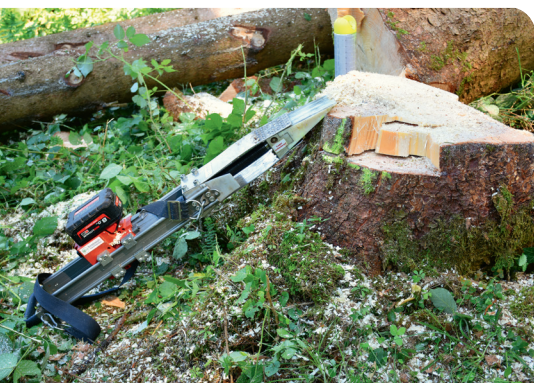
Der gezielte Einsatz von Hilfsmitteln trägt zur Sicherheit bei der Holzernte bei.
