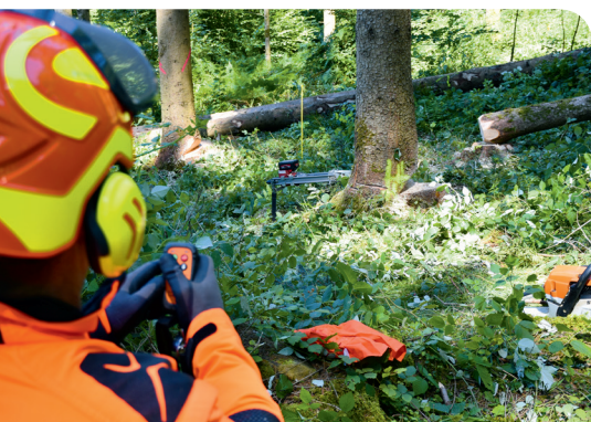
Durch die Funkfernsteuerung bleibt die Bedienperson während des Einsatzes des Funkfällkeils ausserhalb des Fallbereichs.
