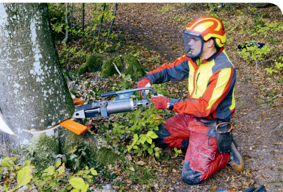
Der hydraulische Fällkeil ermöglicht erschütterungsfreie Keilarbeit. (Bild: Bundesforschungszentrum für Wald (BFW)/Lackner)
