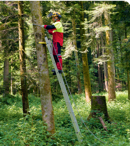
Die Leiter ist auch bei kurzen Einsätzen gegen Abgleiten/Umkippen zu sichern. (Bild: SUVA)
