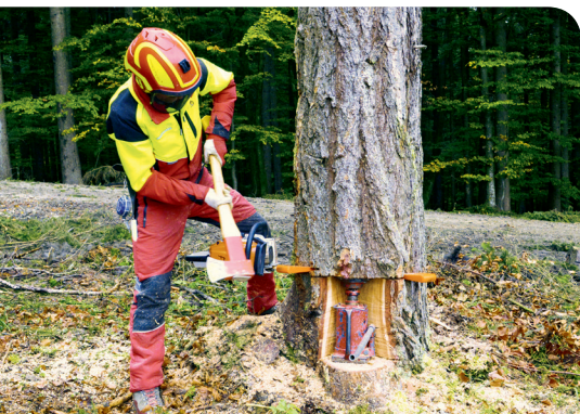
Der hydraulische Fällheber kommt als Alternative zu kraftaufwändiger Keilarbeit bei Bäumen mit grossem Durchmesser oder schrägen Stämmen zum Einsatz. (Bild: Bundesforschungszentrum für Wald (BFW)/Lackner)
