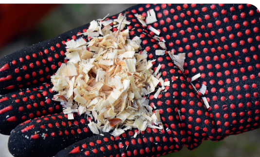
Une chaîne bien affûtée produit des copeaux, une chaîne non affûtée produit de la sciure.
