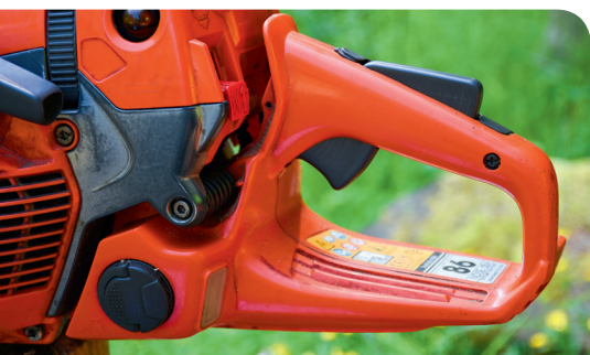
Le blocage de la gâchette d'accélérateur empêche l'actionnement involontaire de l'accélérateur.
