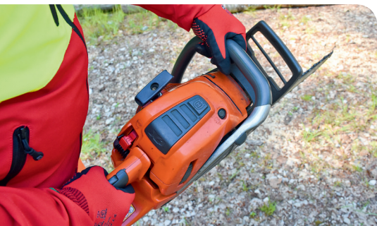
En position de prise latérale, le frein de chaîne ne se déclenche pas en cas de retour.
