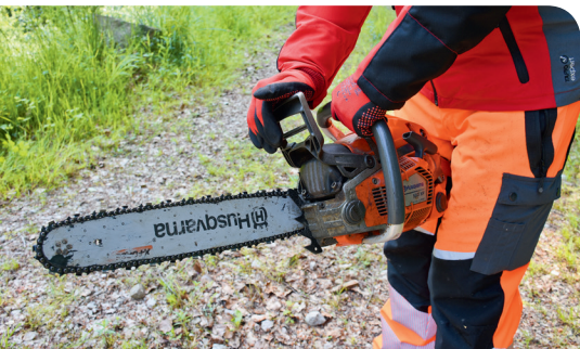
Le frein de chaîne doit arrêter immédiatement la chaîne en mouvement.
